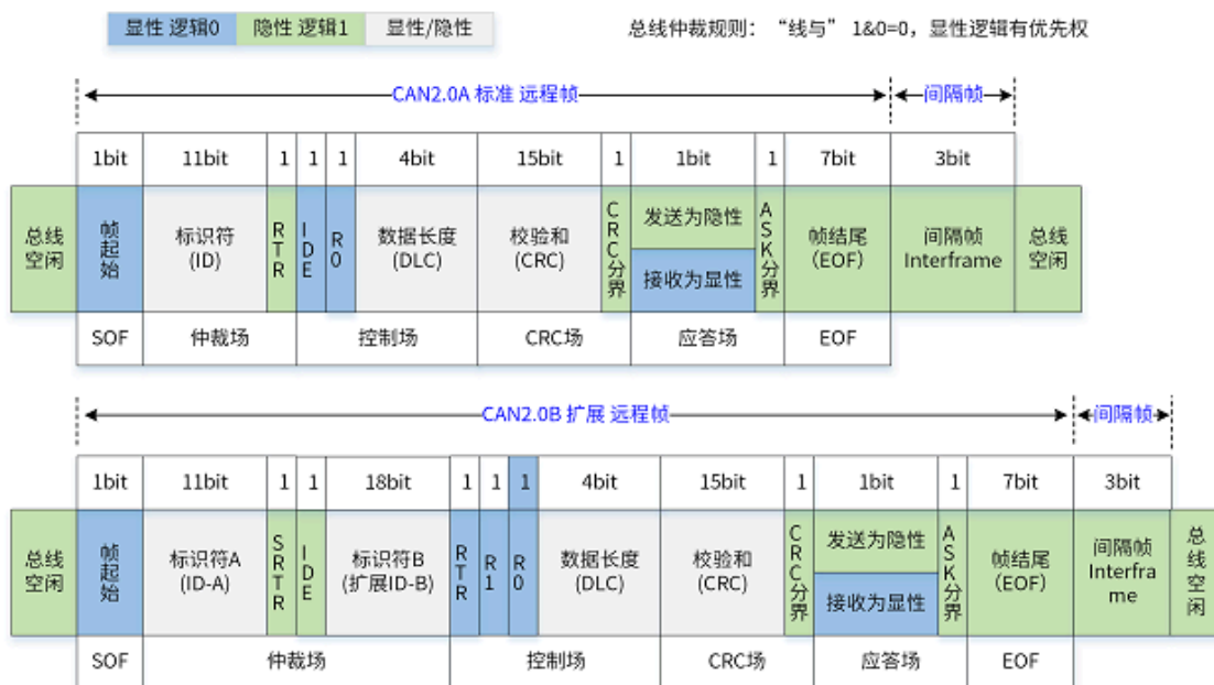
图 7-15 CAN 标准格式和扩展格式远程帧
